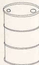
1 Tambor de Óleo dos mais comuns (44 galões), dá para 200 litros de água ou outro líquido.
