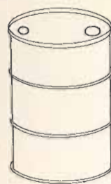
1 Tambor de Óleo dos mais comuns (55 galões), dá para 200 litros de água ou outro líquido.
