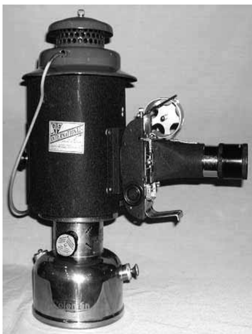
Lampião Coleman 237 com projetor da American Optical acoplado para film strip e slide
